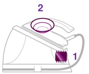
2. Camera Ciclonica Interna che ha il compito di mantenere elevata la pressione del vapore per assicurare la massima potenza e qualità di stiratura senza sgocciolamenti.
